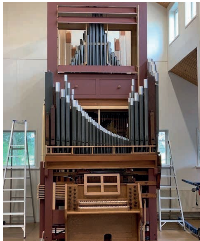
Hele orgelet montert i verkstedet.
